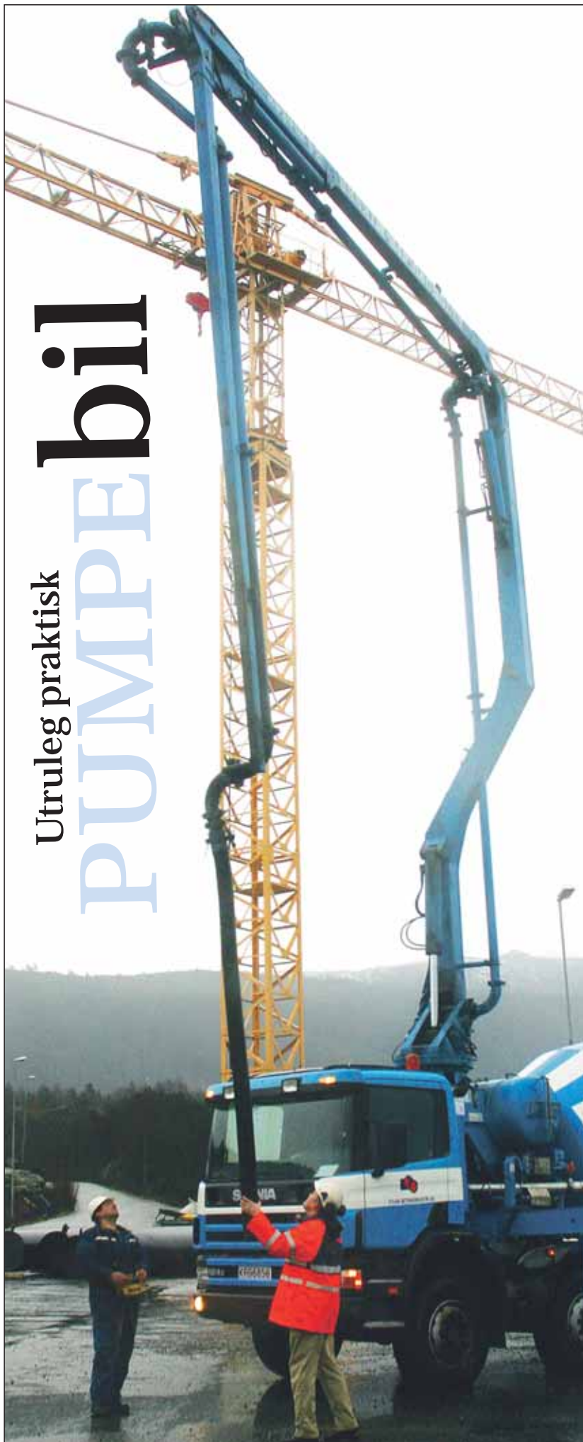
Biletet til venstre: Den nye pumpebilen til Fitjar Betongindustri har ei rekkjevidde på 24 meter. Biletet over: Nils Andreas Brekke og Terje Breivik ventar seg mykje av den nye bilen. Rundt halsen har Terje fjernkontrollen som styrer heile kranopplegget. Foto: Håkon C. Hartvedt
